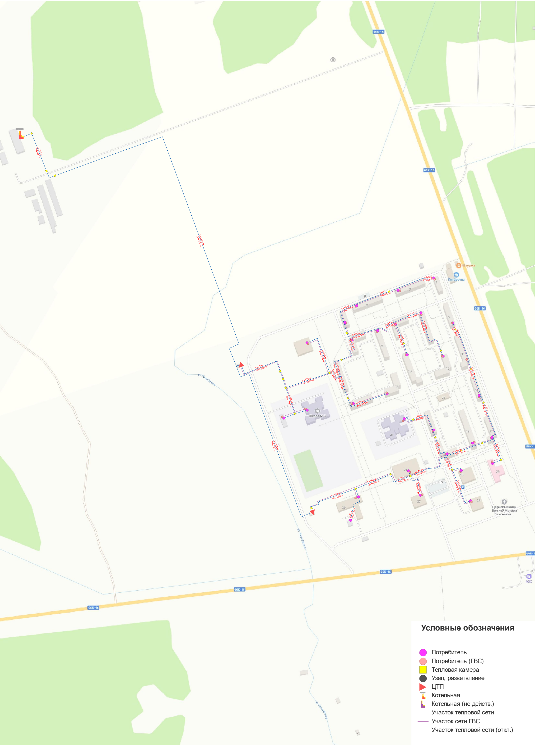
Приложение 3 - Схема теплоснабжения г. Ельня (Котельная №3634)
